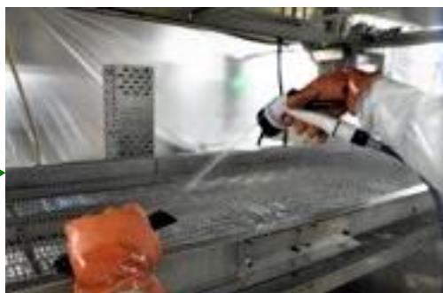
④コンベアを上げ、コンベアの 汚れ除去、流水すすぎ
