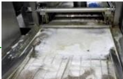
②フライヤー槽に アルカリ洗浄剤を 張り、コンベアを稼働 して90℃浸漬洗浄
