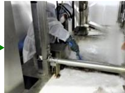
③浸漬時間中フライヤー 外面をアルカリ洗浄剤 で擦り洗い
