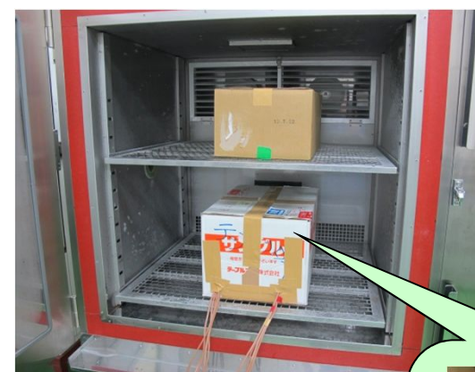
緩慢凍結 (恒温槽内サンプル設置状態)
